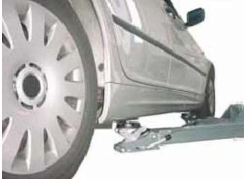
Рис. 1: захваты Mini-Max, установите резиновые подушки под точки подхвата, предусмотренные производителем
