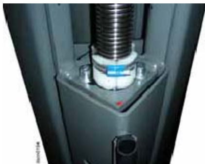
Рис. 18: штифт износа несущей гайки отмечен красным цветом.
