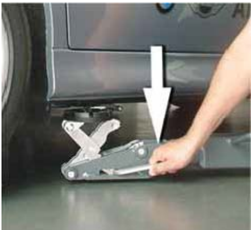
Рис. 2: нажмите на рычаг, чтобы поднять опоры к точкам подхвата.
